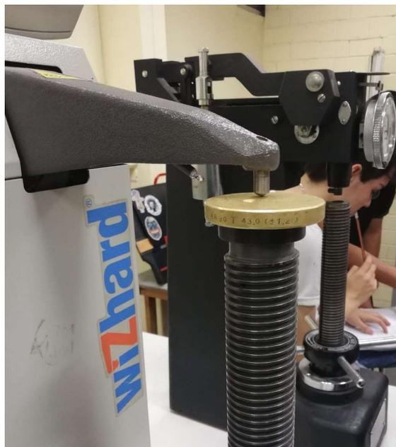
Cuando el tiempo de carga término, se retiró la probeta del plato y se examinó la medida de la huella mediante el microscopio y la linterna. Cabe destacar que se utilizó un marcador de tinta para facilitar la identificación de la huella en el microscopio.
