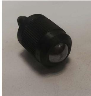
Primero se conectó el durómetro a la corriente eléctrica. Seguido de esto se configuró el ensayo para ser con la escala Brinell HB y se escogió la configuración del penetrador de bola con HB 10/100 10mm.
